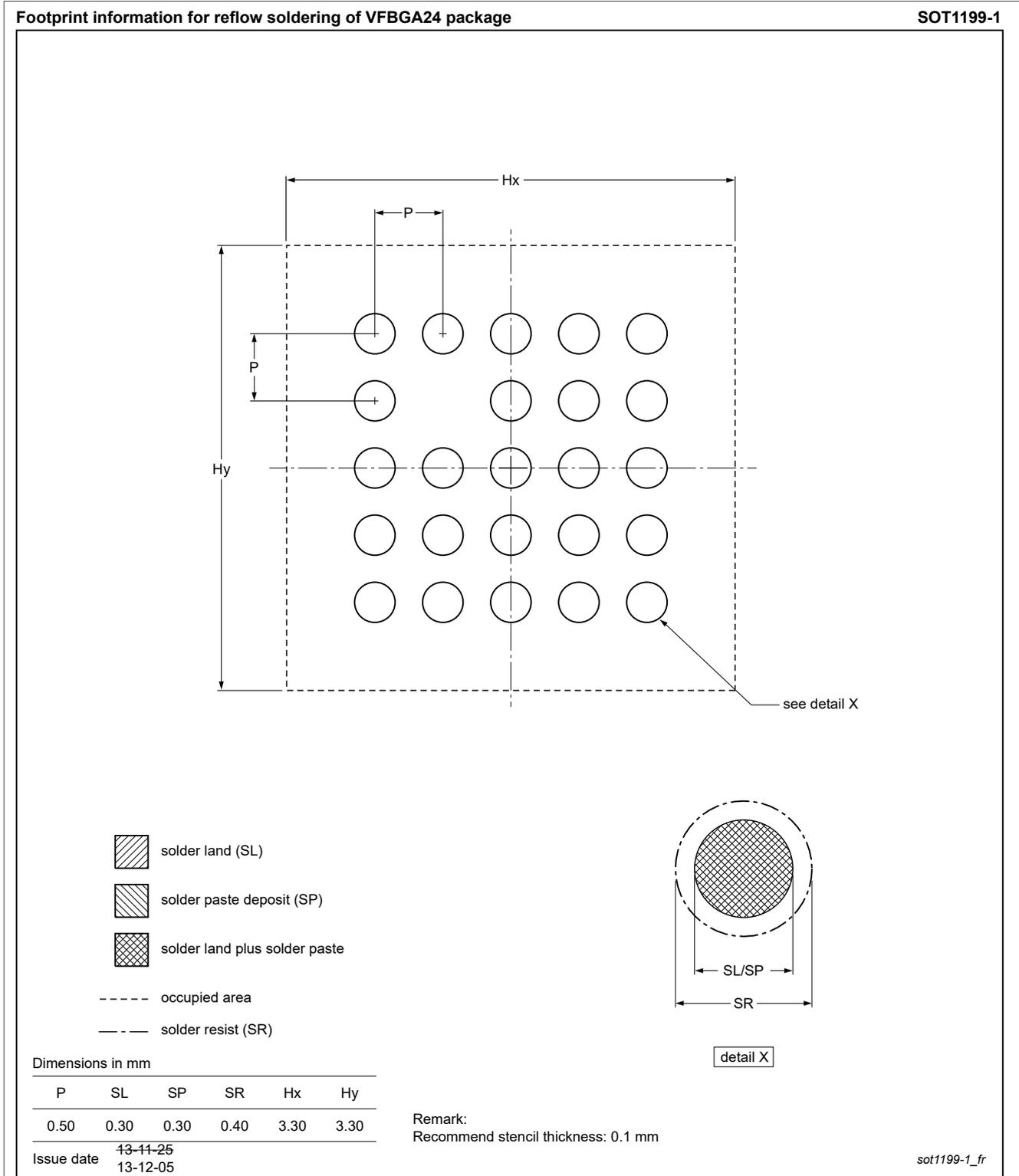
Figure 42. PCB footprint for SOT1199-1 (VFBGA24); reflow soldering
