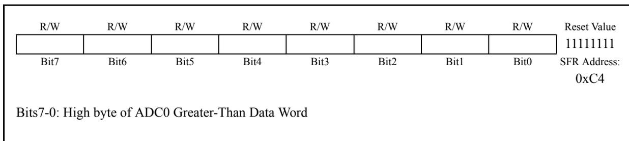
**Figure 5.12. ADC0GTL: ADC0 Greater-Than Data Low Byte Register**
