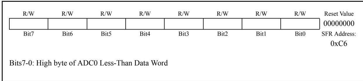
**Figure 5.14. ADC0LTL: ADC0 Less-Than Data Low Byte Register**
