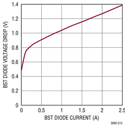
**Catch Diode Voltage Drop (V<sub>GND</sub> - V<sub>SW</sub>) vs I<sub>sw</sub>**
