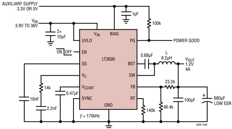
(POWER GOOD IS ONLY VALID WHEN EN IS HIGH AND  $V_{IN} > 3.9V$ )
