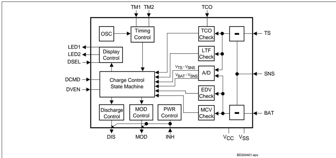
**Figure 3. Block Diagram**
