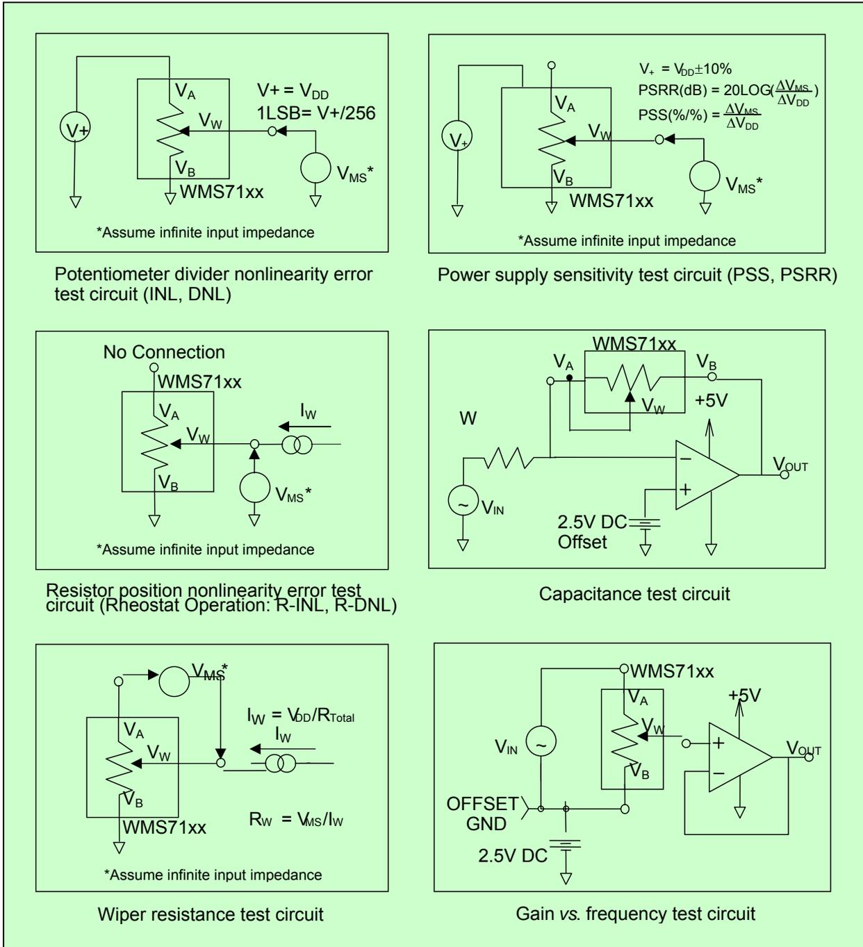
FIGURE 4 – TEST CIRCUITS
