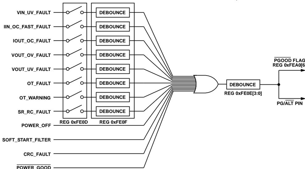
Figure 30.  $\overline{\text{PGOOD}}$  Programming
